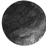
② Fatigue fracture
